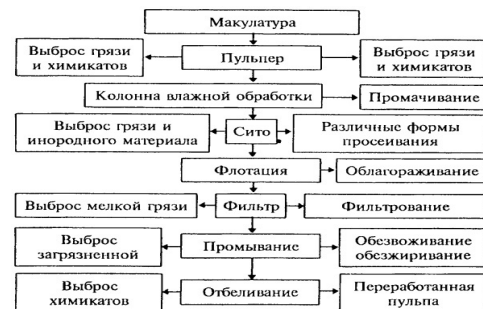
Рисунок 3 – стадии переработки макулатуры
